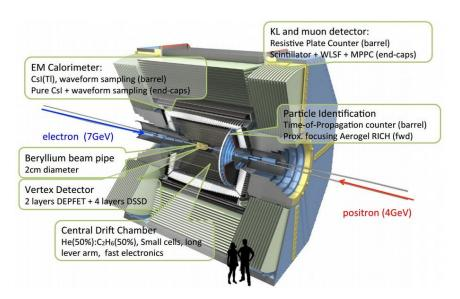
Figure 5.30: Une représentation schématique du détecteur Belle II
