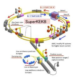
Figure 5.29: Une représentation schématique du l'accélérateur SuperKEKB
