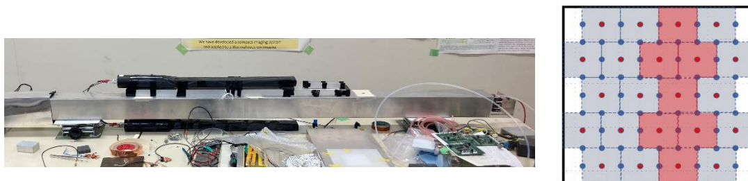
図 4.13 多線式比例計数管の全体図(左)とセル(右)
