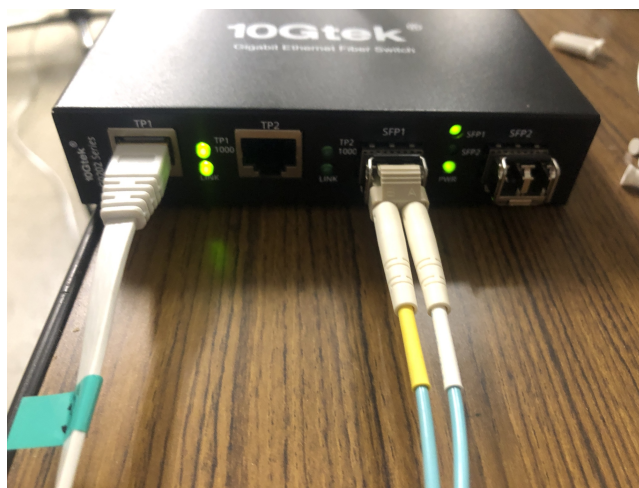
図 29 メディアコンバーター。オプティカルファイバーの情報を LAN ケーブルに変換している。
