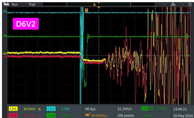
図 7.6: 2024 年 5 月 20 日 23 時頃に発生した SBL に伴う D6V2 コリメータの音響センサー信号。チャンネル 1,3 は図 5.11 の AE26, AE27 のセンサーである。
