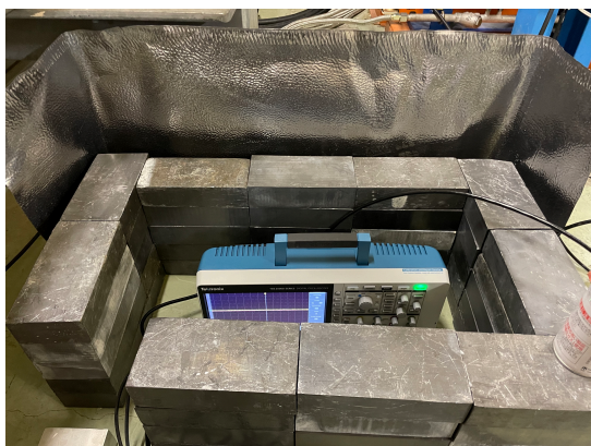
図 5.13: D6V2 のオシロスコープを鉛ブロックで囲う様子
