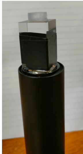
(b) 下から PMT・ライトガイド・シンチレーター
