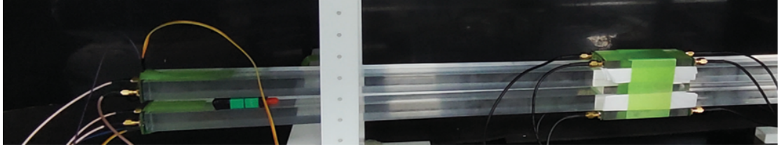
图 2.7 KLM 升级中的塑闪测试
