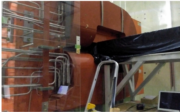
図 4.1: 北カウンターホールの双極電磁石
