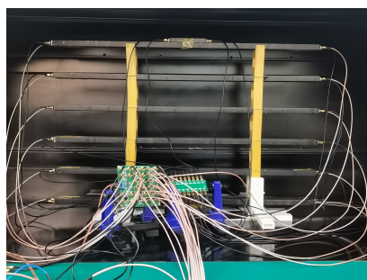
图 4-20 有六层闪烁体探测器的原型样机测试装置实物图。
