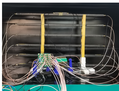
图 4-24 宇宙线测试的装置图。
