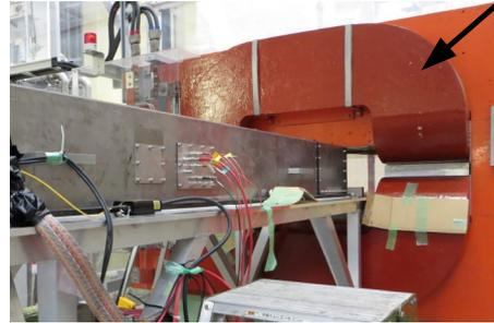
図 4.2: 磁場試験用セットアップの磁石と暗箱。アルミニウム製の暗箱全体を磁石内部に挿入する形式をとる。
