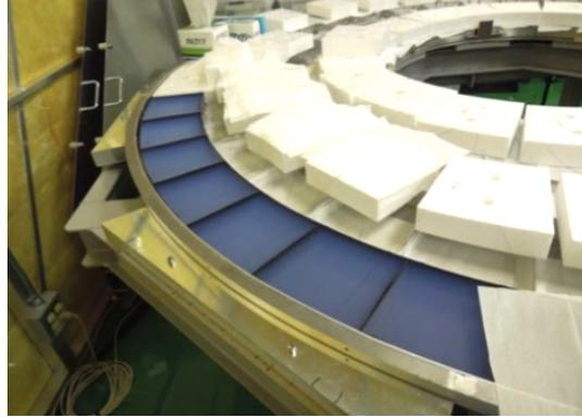
図 2.8: 実際にフレームにインストールされたエアロゲル
