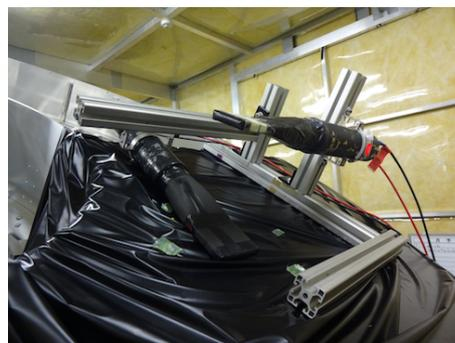
図 5.2: トリガーカウンターの写真。シンチレータと PMT を組み合わせて作成し支持フレームの法線方向に中心が一致するよう 20 cm 間隔で配置した。
