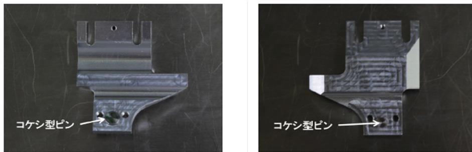
図 2.17: BW 側エンドマウントの写真。左が表面、右が裏面を表している
