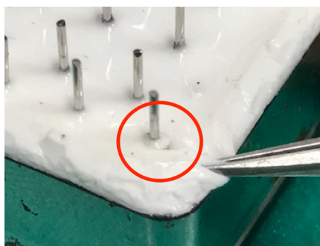
図 4.16: 試験後のシリコンポッティングの様子
