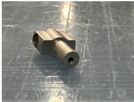
図 4.13: MCP-PMT のピン周辺のシリコンポッティングだけに負荷をかけるためのボルト
