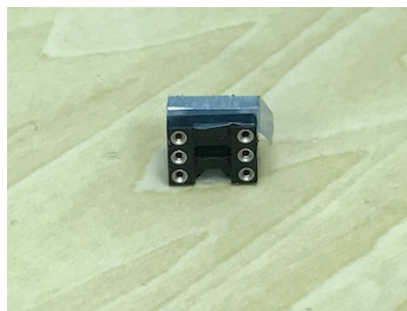
図 4.8: MCP-PMT のピンだけに負荷をかけるテストに使用したソケット
