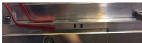
図 3.2: 2 ゲージ法。測定したい対象の表裏にストレインゲージを接着している。
