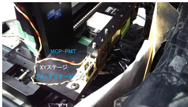
(b) XY ステージ上のフォトダイオードと MCP-PMT
