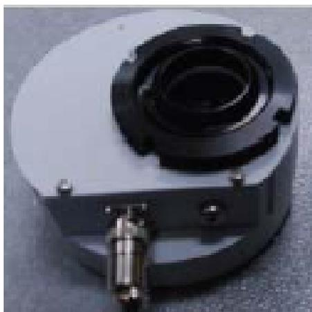
図. 3.5: 可動フィルタホルダユニットの写真
