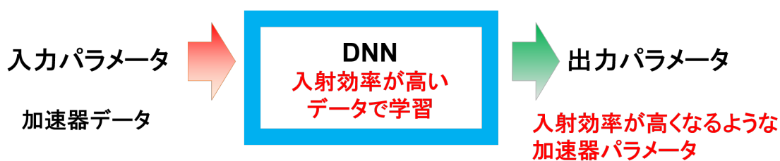
図4.1 DNN を使用した加速器運転パラメータの予測の流れ
