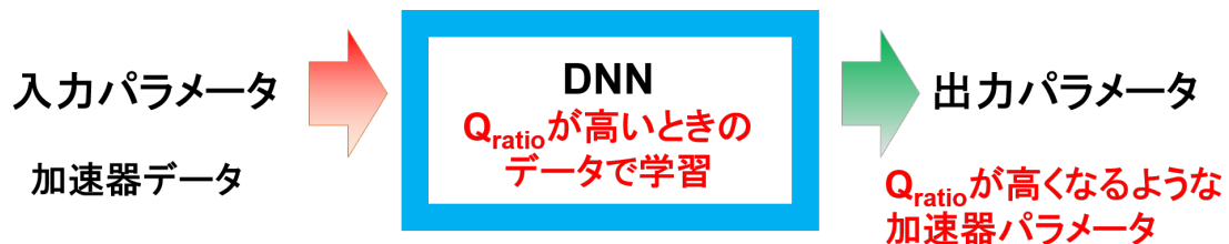
図4.4 DNN を使用した加速器運転パラメータの予測の流れ ( Q_{ratio} を用いた場合)
