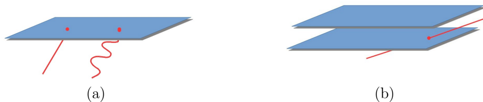
FIGURE 4.21 – Illustration de particules traversant une seule face du détecteur.
