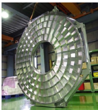
図 51 Aerogel タイルをセットするアルミニウムフレーム
