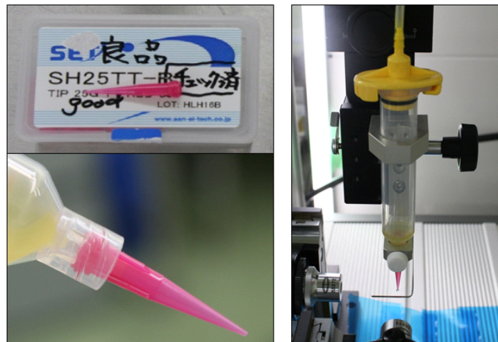
図 5.9: 左：使用するノズル (SH25TT-B(25G)) 右：直交ロボへのシリンジ取り付け
