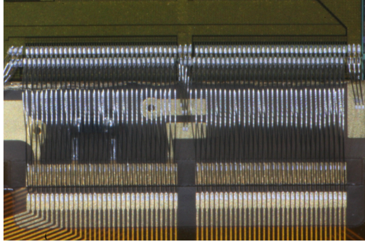
図 5.41: ボンディング後の APV25 \leftrightarrow PA0(1チップ分)の拡大写真
