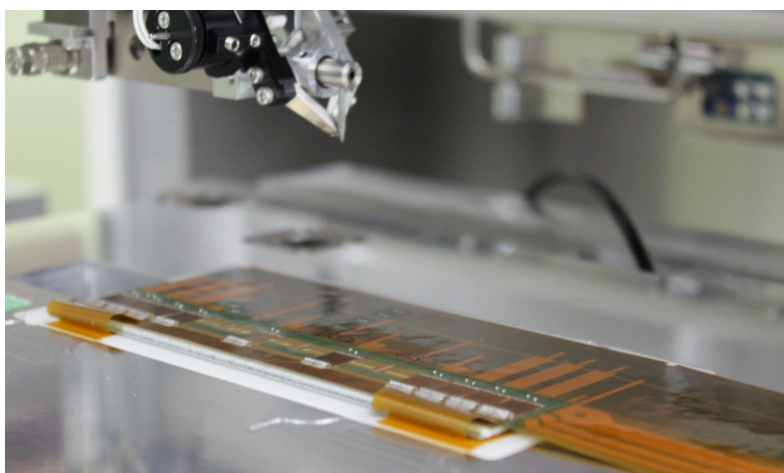
図 5.36: パラメータサーチのための S.M. へのボンディング
