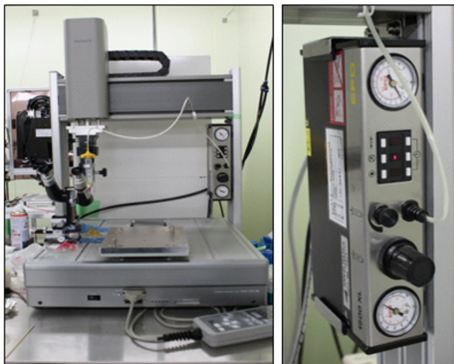
図 5.7: 左 : 直交ロボ (SONY CAST PRO II) 右 : ディスペンサー (1500XL, EFD)
