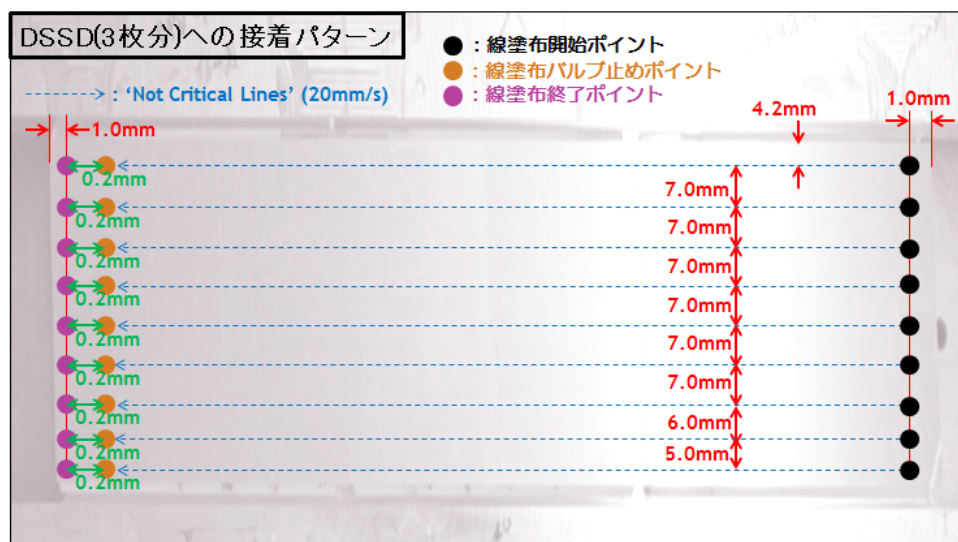
図 5.28: DSSD への接着パターン
