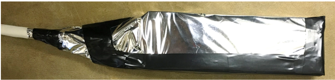
図 4.6: アルミマイラーとケーブルを導通させ、静電遮蔽したところ。
