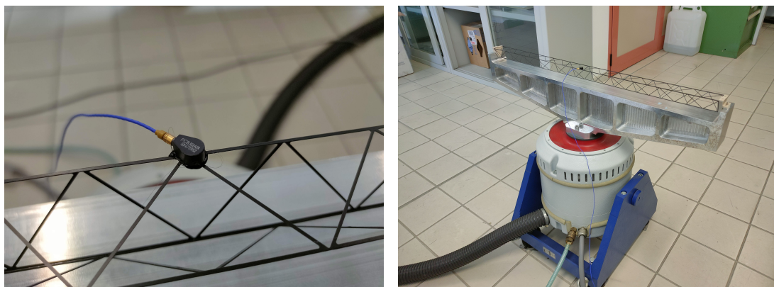
Figura 4.35: A sinistra il posizionamento dell'accelerometro, fissato al traliccio utilizzando della colla a caldo. A destra l'apparato di misura con supporto di alluminio e traliccio fissati allo shaker che sottopone la struttura a vibrazione.
