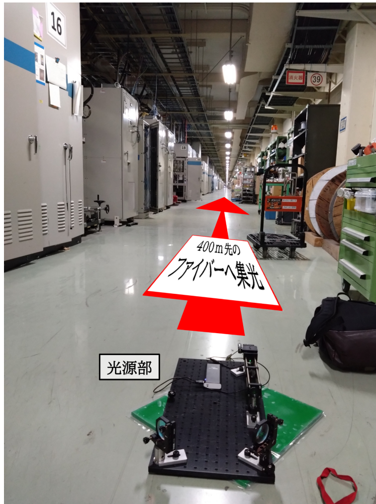
図 4.4.4 レーザー光源側から見た 400 m の様子. 赤矢印の先にファイバーなどの集光部光学系を設置している.
