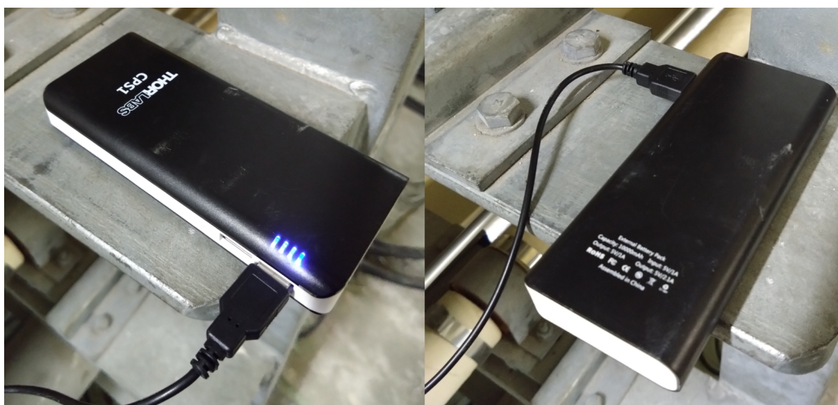
図 B.0.5 レーザー光源用 5 V 電圧供給バッテリー. 近くから電源を取って来れない時に使用する. USB コネクタなので USB-フォノケーブルでフォノ端子のレーザー光源に接続する.
