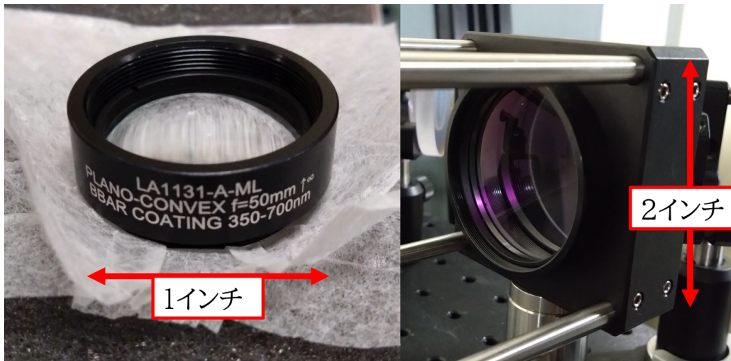
図 B.0.14 \phi N-BK7 平凸球面レンズ、直径が 1 インチ (左) のものと 2 インチ (右) のもの。写真は左から順に焦点距離が 50 mm、200 mm のレンズ。
