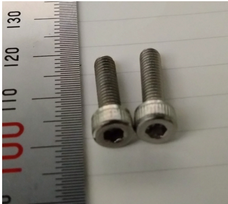
図 B.0.12 M4 ネジ. ポストにキネマティックマウントを固定するために用いる.
