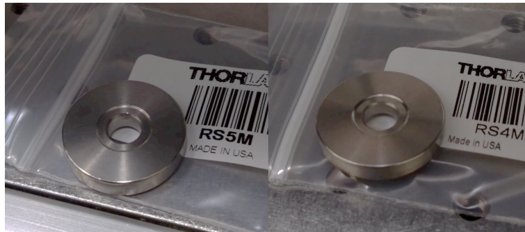
図 B.0.9 ポストスペーサ. キネマティックマウントとポストの間に咬ませて任意の高さに変える. RS5M (左) は 5mm、RS4M (右) は 4mm の厚みがある. 前者は RS1.5P\ M 及び と、後者は RS2P\ M と用いてミラーの中心の高さが 80mm となるようにしている.
