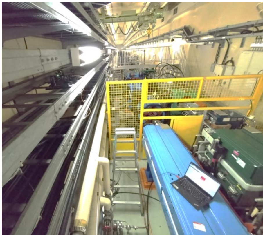
図 4.5.6 ファイバー集光量測定の様子。ファイバーと PM-16-120 はこれまでと同様ファイバーアダプターキャップ (S120-FC) で接続している。双極磁石の上にあるパソコンでファイバー集光量を表示させている。この写真の右側の黄色い柵が D6/D7 の境界であるイエローフェンス。
