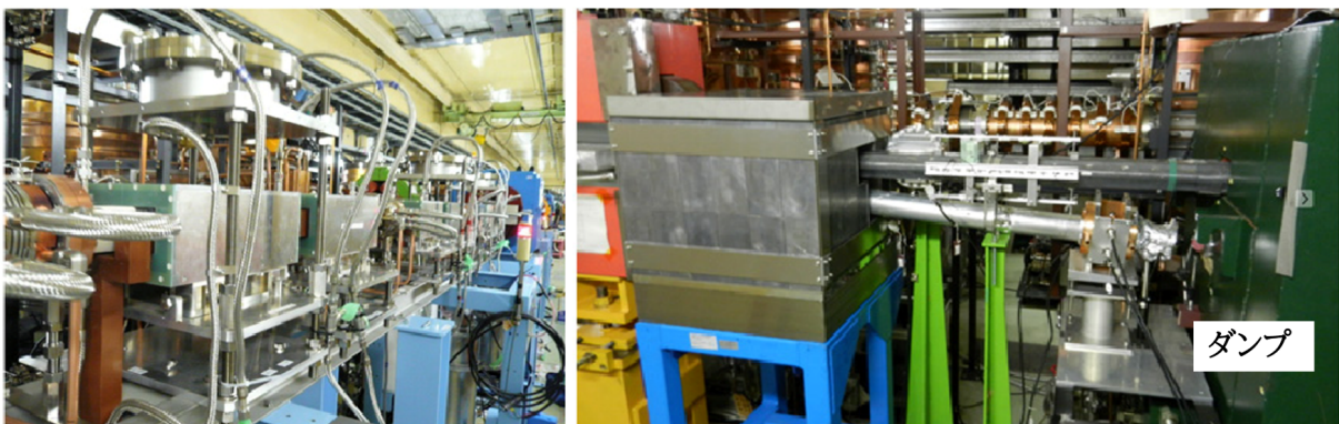
図 2.4.4 水平キッカー電磁石 (左) とビームダンプ (右)[34].
