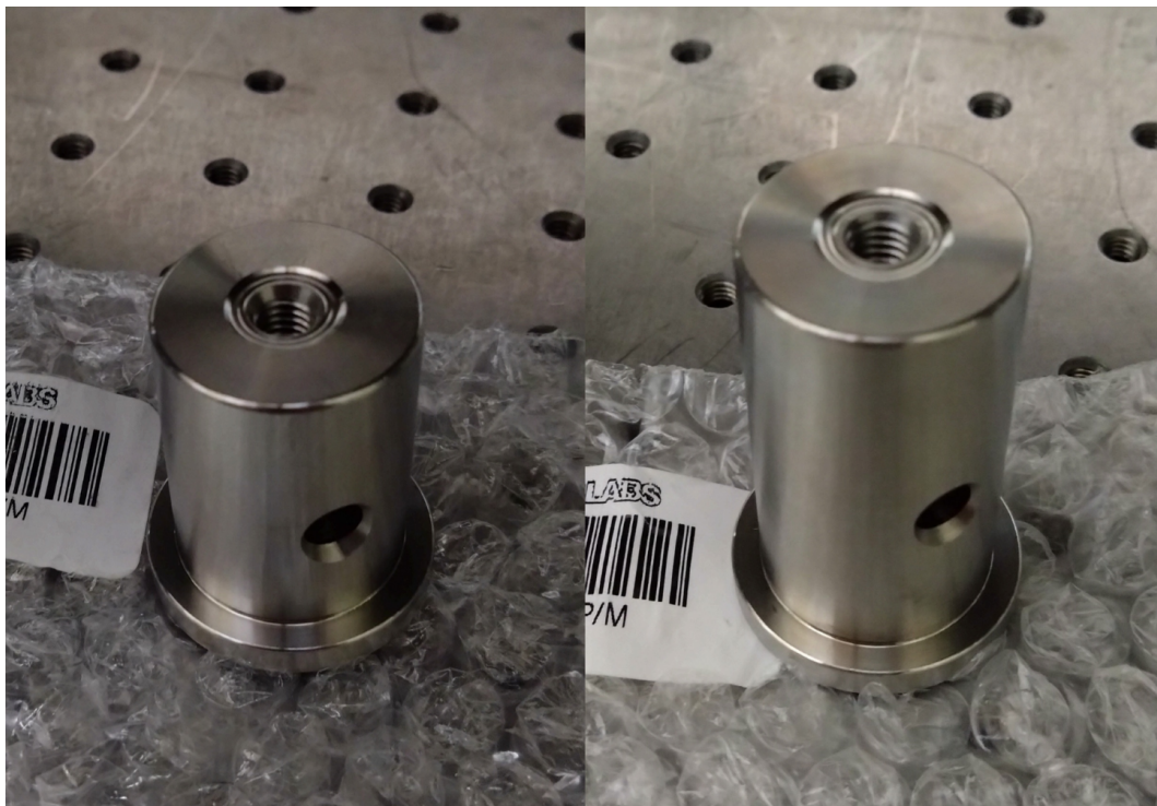
図 B.0.8 ピラーポスト. 高さが 1.5 インチ (=38mm の RS1.5P\ M (左) と、2 インチ (=50mm の RS2P\ M (右). 前者は 2 インチミラー、後者は 1 インチミラーの台として用いる.
