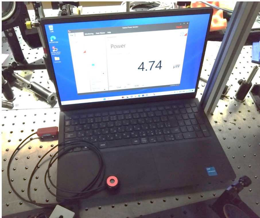
図 4.5.5 PM16-120 - USB パワーメータ (標準型フォトダイオードセンサ付き、Si、400~1100 nm、50 mW Max) を USB コネクタで、専用のソフトウェア (NI VISA) [64] をインストールしたパソコンに繋いだ様子. データは .CSV 形式で保存される.
